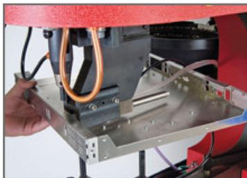
底部自动送料 J 型钩用于加工难以触及的折弯边角
