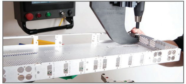
手动 J 型钩搭配 24" (610 毫米) 喉深
