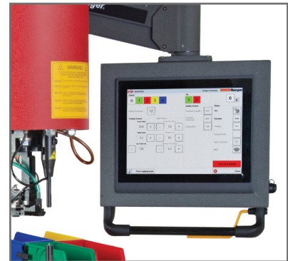
操作员可在六个方向调节控制面板
