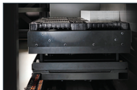
C: 自动加载工件托盘。
