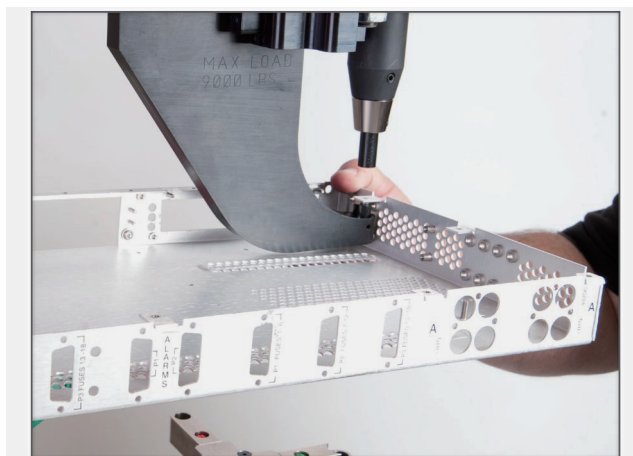
手动J型钩 用以加工小型折弯件
