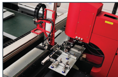
D: 单次运行中可在工件两面压接多达6种不同的硬基材工件。
