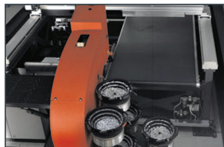
A: 安装多达6个MAS-350模块化自动送料系统。
