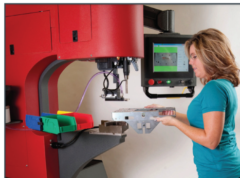
操作员可在6个方向调节控制面板
