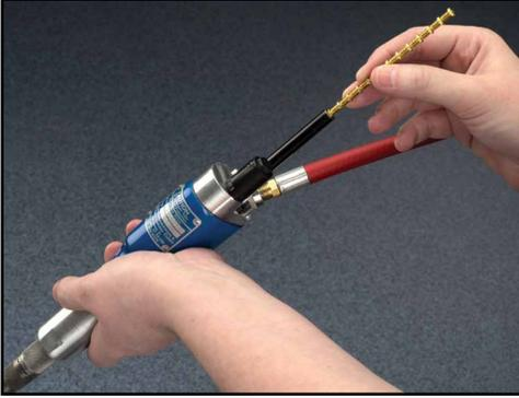
1) 加载 - 将杆插入驱动器的背面, 然后传送至第二个螺钉处。
