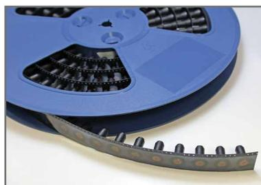
用 330 毫米可回收卷盘载带包装, 载带宽度为 24 毫米。提供真空拾取用聚酰亚胺贴片。卷盘符合 EIA-481 标准。
