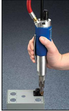
2) 驱动 - 挤压扳手启动驱动器。将旋转螺钉的尖端放入孔中后驱动螺钉归位, 当达到精确的固定扭矩时, 将螺钉完全拧下。下一个螺钉将自动传至驱动位置。
