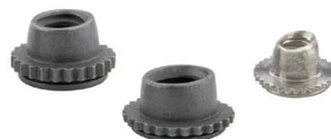
FEX™/FEOX™/U™ 型螺母具有可重复使用的 2B/6H 级螺纹。这些紧固件可以安装在较薄的板材中,并且比标准的自扣紧螺母更接近板材边缘。FEX/FEOX/U 的某些规格型号可根据 NASM45938/7 规格<sup>(2)</sup>订购。
