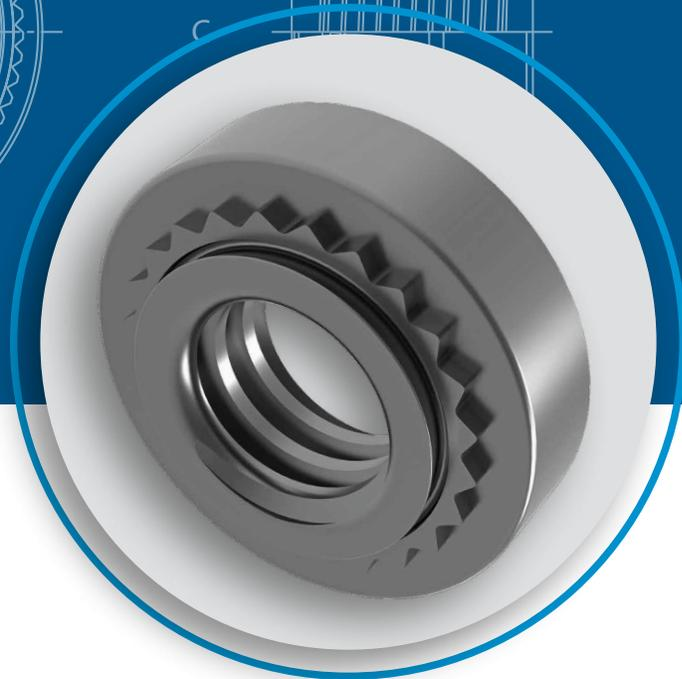
自扣紧螺母的安装方法是将它们放入安装板上相应尺寸的孔中, 然后向螺母头部施加平行挤压力。螺母头部周围的安装板材料发生冷变形流入容槽, 从而使紧固件成为安装板的组成部分。齿形排料器可以防止安装后的紧固件发生转动。
