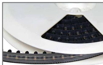
用 330 毫米可回收卷盘载带包装，载带宽度为 24 毫米。提供真空拾取用聚酰亚胺贴片。载带符合 EIA-481 标准。
