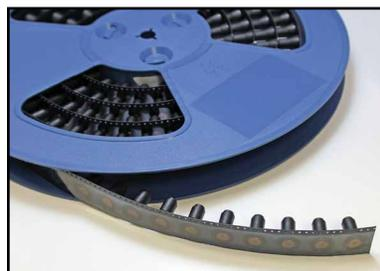
用 330 mm 可回收卷盘胶带包装载带宽度为 24 mm。提供真空拾取用聚酰亚胺贴片。卷盘符合 EIA-481 标准。
