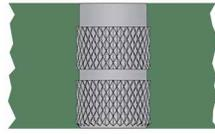
注意：“A”尺寸以外留下最大 .025 英寸/0.65 毫米的轻微凸出。
