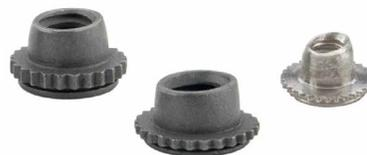
FEX™/FEOX™/U™ 型螺母具有可重复使用的 2B/6H 级螺纹。这些紧固件可以安装在较薄的板材中,并且比标准的自扣紧螺母更接近板材边缘。FEX/FEOX/U 的某些规格型号可根据 NASM45938/7 规格(2)订购。
