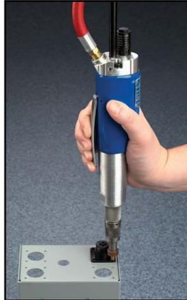
2) 2) Accionamiento - Apretar el gatillo para poner en marcha el atornillador. Colocar la punta del tornillo giratorio en el orificio y el tornillo se introduce, girando limpiamente cuando se alcanza el torque de asentamiento preciso. El siguiente tornillo se coloca automáticamente en la posición de accionamiento.
