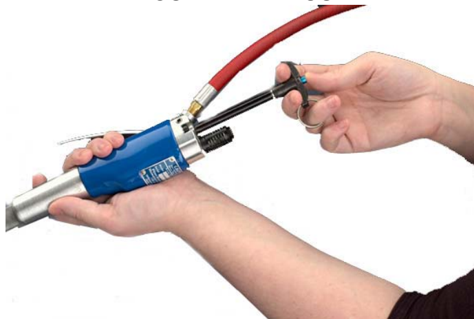
FIGURA 2 REGULAÇÃO DO CURSO DA FERRAMENTA PARA PARAFUSOS DE DIVERSOS COMPRIMENTOS
