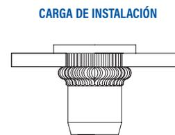
La **carga de instalación** es la fuerza requerida para colapsar (bulbo) el inserto en el rango de agarre especificado (grosor de la aplicación).
