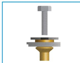
**ステップ 4** 取り付けツールのマンドレルを取り外し、ファスナーにねじを取り付けられるようにします。
