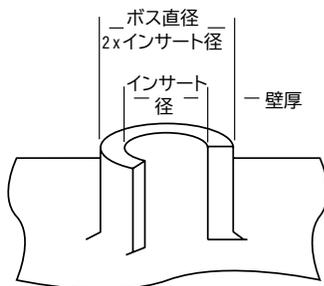
壁厚が薄くても取り付けは成立しますが、強度は低下します。
